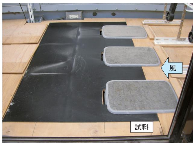
第2図 風洞実験状況(風洞内)
