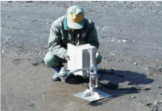
第4図 日射反射率計測状況
