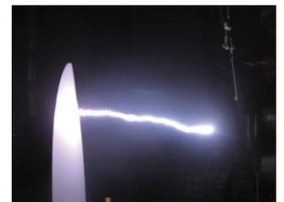
ブレードへの雷撃模擬試験
