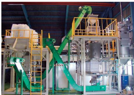
固体アルカリ反応方式フロン類破壊処理装置
