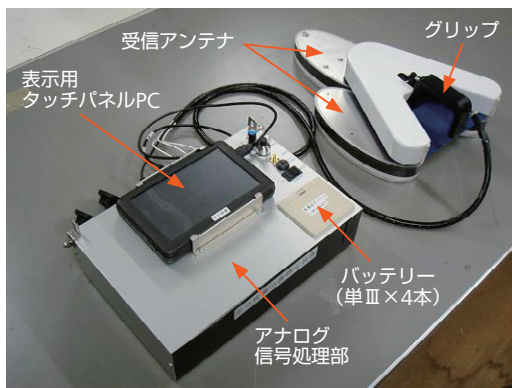
第2図 部分放電位置標定装置の外観
