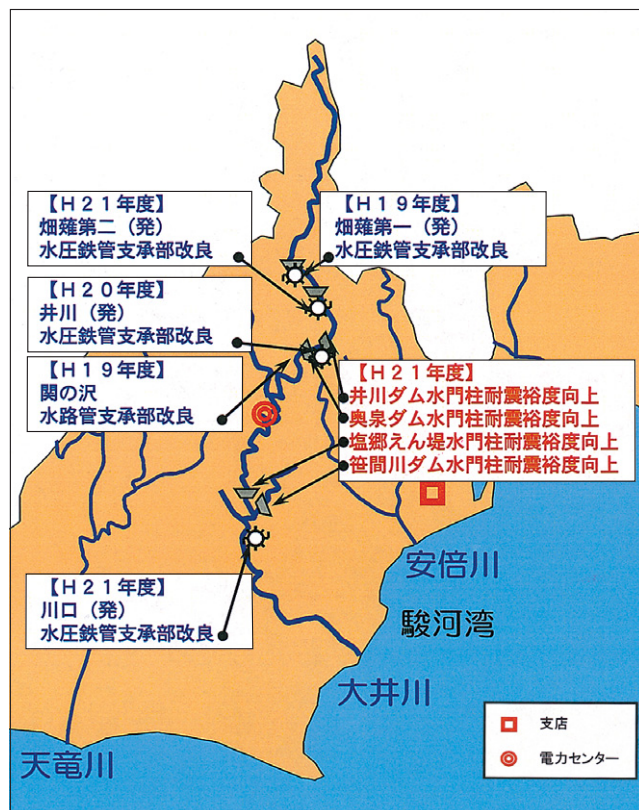
第1図 耐震裕度向上対策状況
