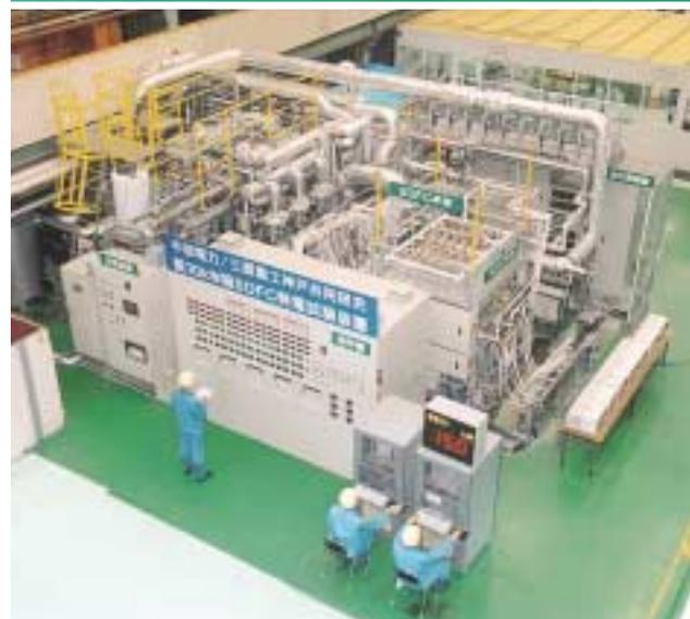
数10kW級固体酸化物形燃料電池発電試験装置(下)と電池スタック(上)
