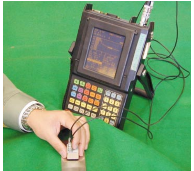
第4図 超音波による粒界腐食測定
