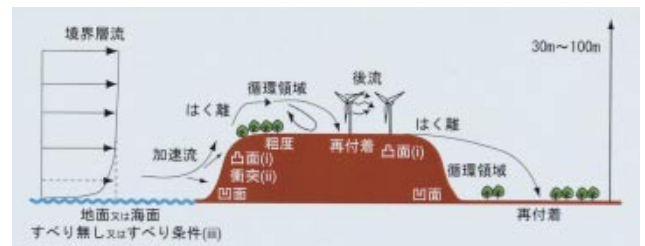
第1図 風車設置周りの地表条件および風況
