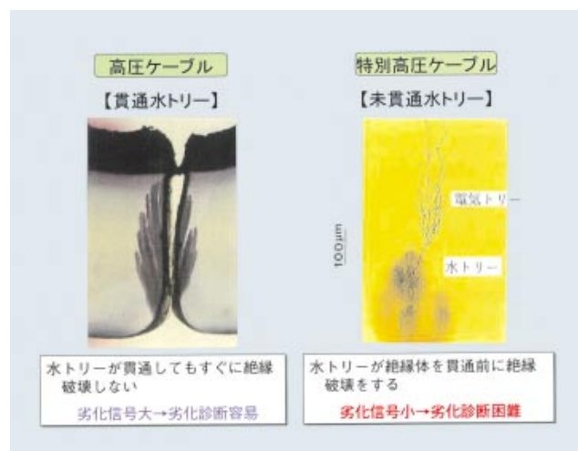
第1図 高圧・特別高圧の水トリー
