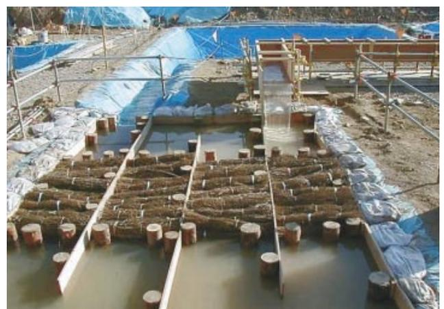
第4図 仮沈殿池実験状況
