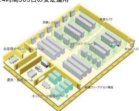
データセンター設備
