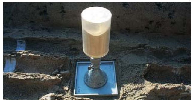
第3図 砂置換による締め固め度試験
