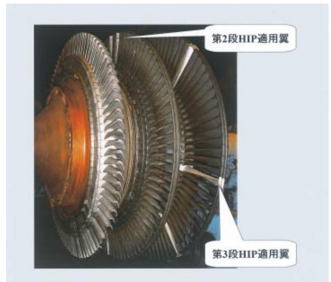
第6図 HIP適用翼の実機への組み込み状況
