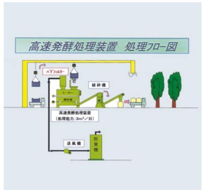
第3図 高速発酵処理装置 処理フロー図
