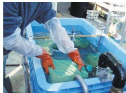
写真1 500ℓ水槽での温湯殺菌試験
