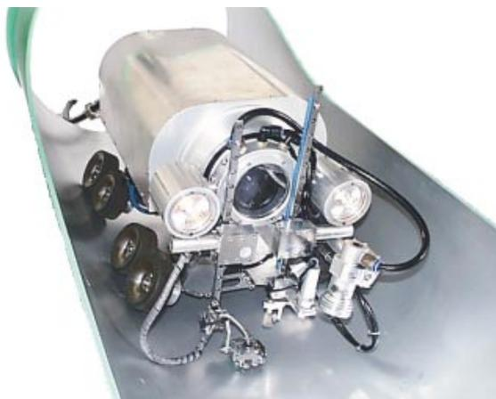
写真2 微粉炭管内面検査ロボット
