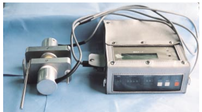
第6図 超音波式劣化診断装置の外観
