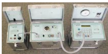
第22図 活線劣化診断装置（量産モデル）
