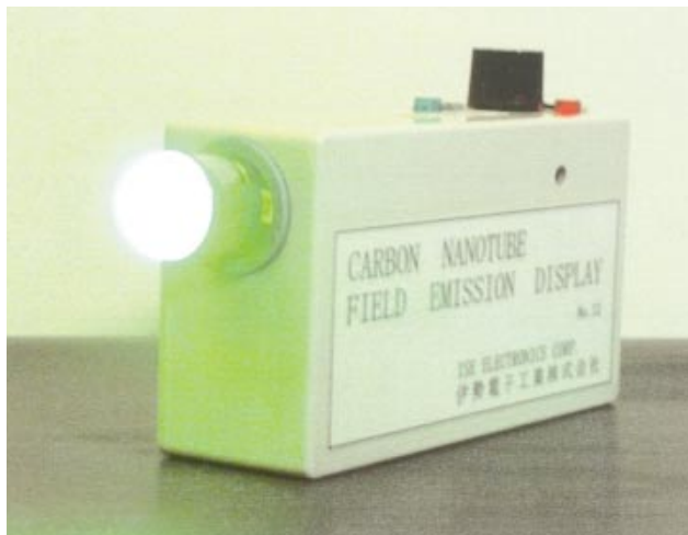
第13図 高配向カーボンナノチューブを用いた発光デバイス
