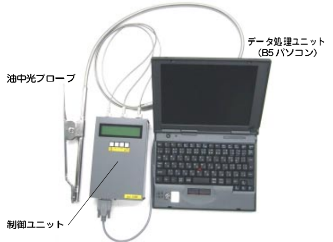
第5図 柱上変圧器の間接劣化診断装置(外観)
