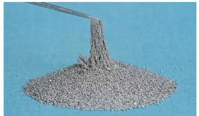
第6図 磁気作業物質 (ガドリニウム系合金)
