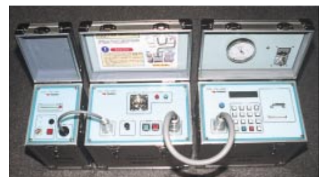
6kV級CVケーブル活線劣化診断装置
