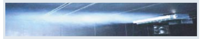
第8図 コアング効果利用水平吹付け方式 (気流可視化実験の様子)
