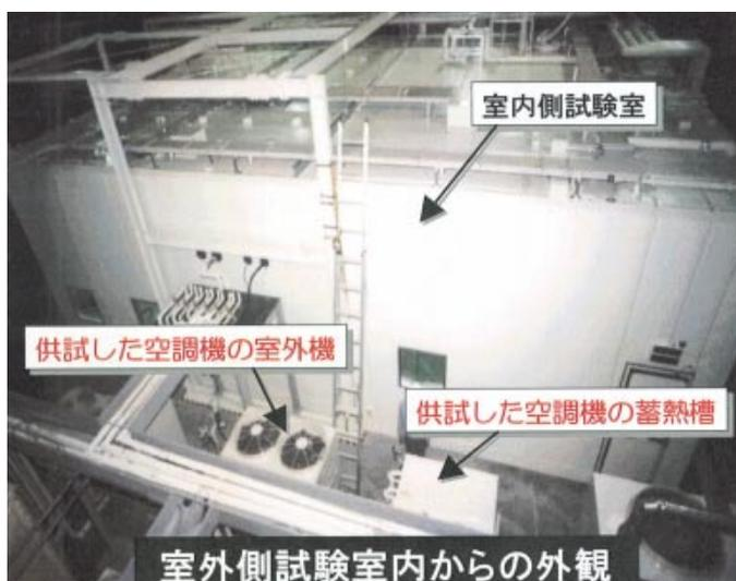
第2図 大型空調試験装置の外観
