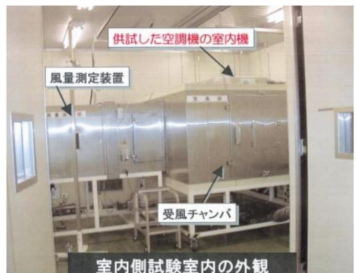
第3図 小型空調試験装置の外観
