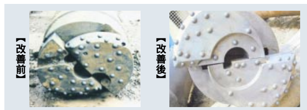
第5図 削孔ビット
