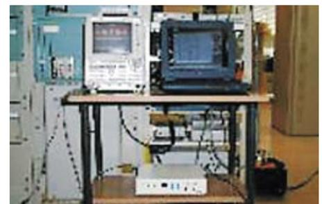
配電線自動化装置障害判定測定器
