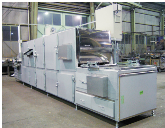
第2図 電気式焼成機の外観写真
