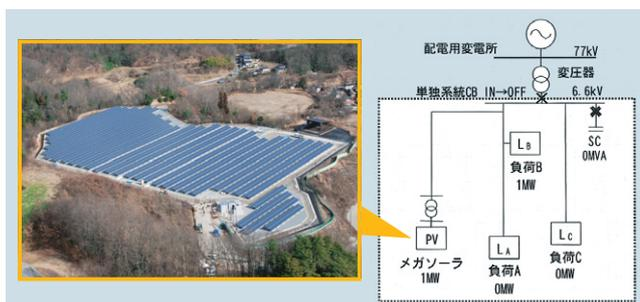
第6図 配電系単独系統解析の試験系統
