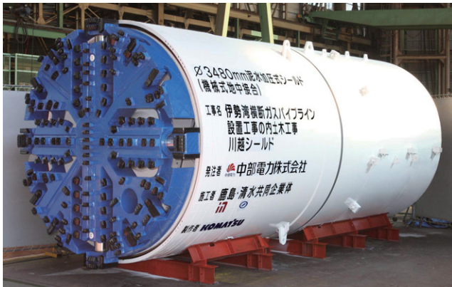
第3図 川越側シールドマシン
