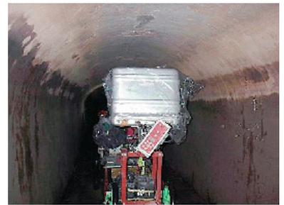
第3図 レーザー測距式内空断面測定装置
