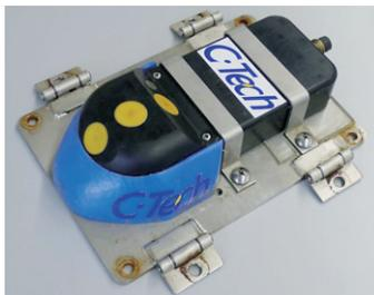
第2図 超音波ドップラー式流速計
