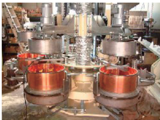
第1図 回転式連釜(6連釜)の外観 [引用:(株)ミハマ製作所WEBサイト]
