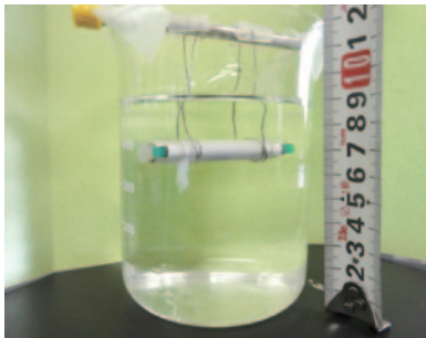
第3図 本研究で成長を確認した人工珊瑚結晶(長さ5cmのアルミナケースからはみ出ている白い部分が人工珊瑚結晶)
