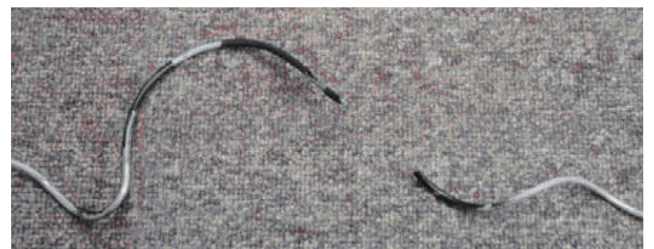
第2図 疲労破断した巻付バインド
