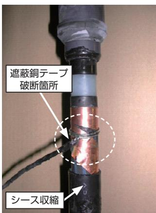
第2図 遮蔽銅テープが破断したCVケーブル
