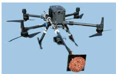
第6図 電極棒を搭載した特殊仕様のドローン
