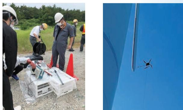
第8図 ドローンを用いた導通確認の様子
