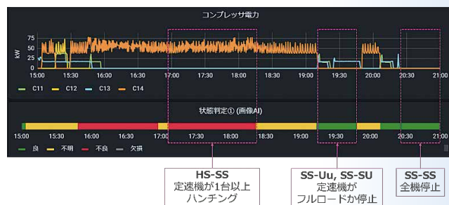
第4図 運転状態良否判定結果の表示例
