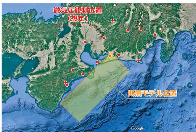
第4図 断層モデルならびに微気圧観測位置
