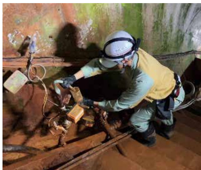
第2図 ダム揚圧力計測業務
