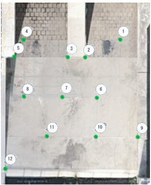
第5図 えん堤排砂路水平部における標定点 (GCP) 配置位置の概要
