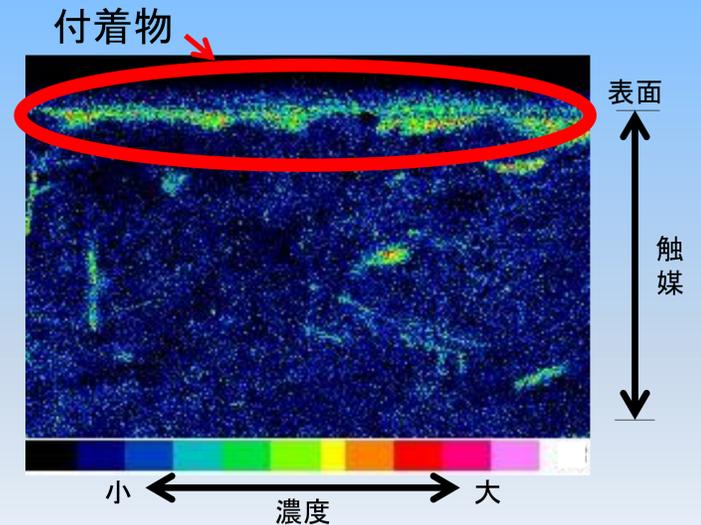
脱硝触媒断面のケイ素の分布
