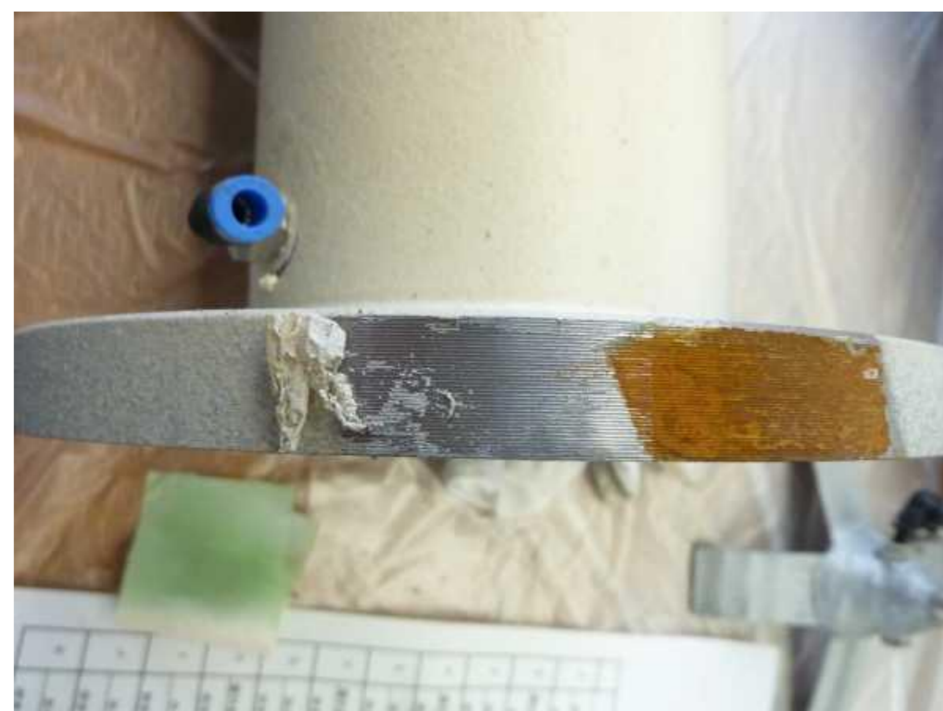
図-3 シリコンゴムコーティングを剥がした状態
