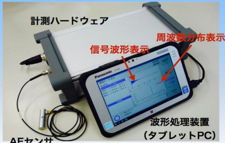
AEセンサを用いた打音検査装置
