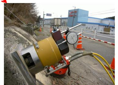
のり面のアンカー緊張力状態を面的に把握可能 + 継続的な計測が可能
