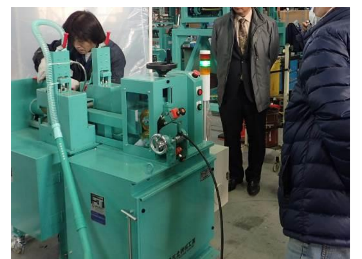
② ケーブル分解装置で分解
