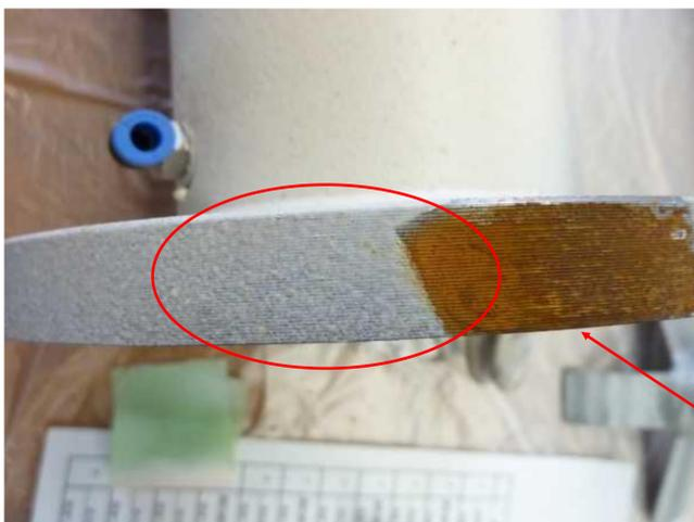
鉄材の一部にシリコンゴムを吹き付け、塗布していない箇所との錆の発生状況を確認した。
