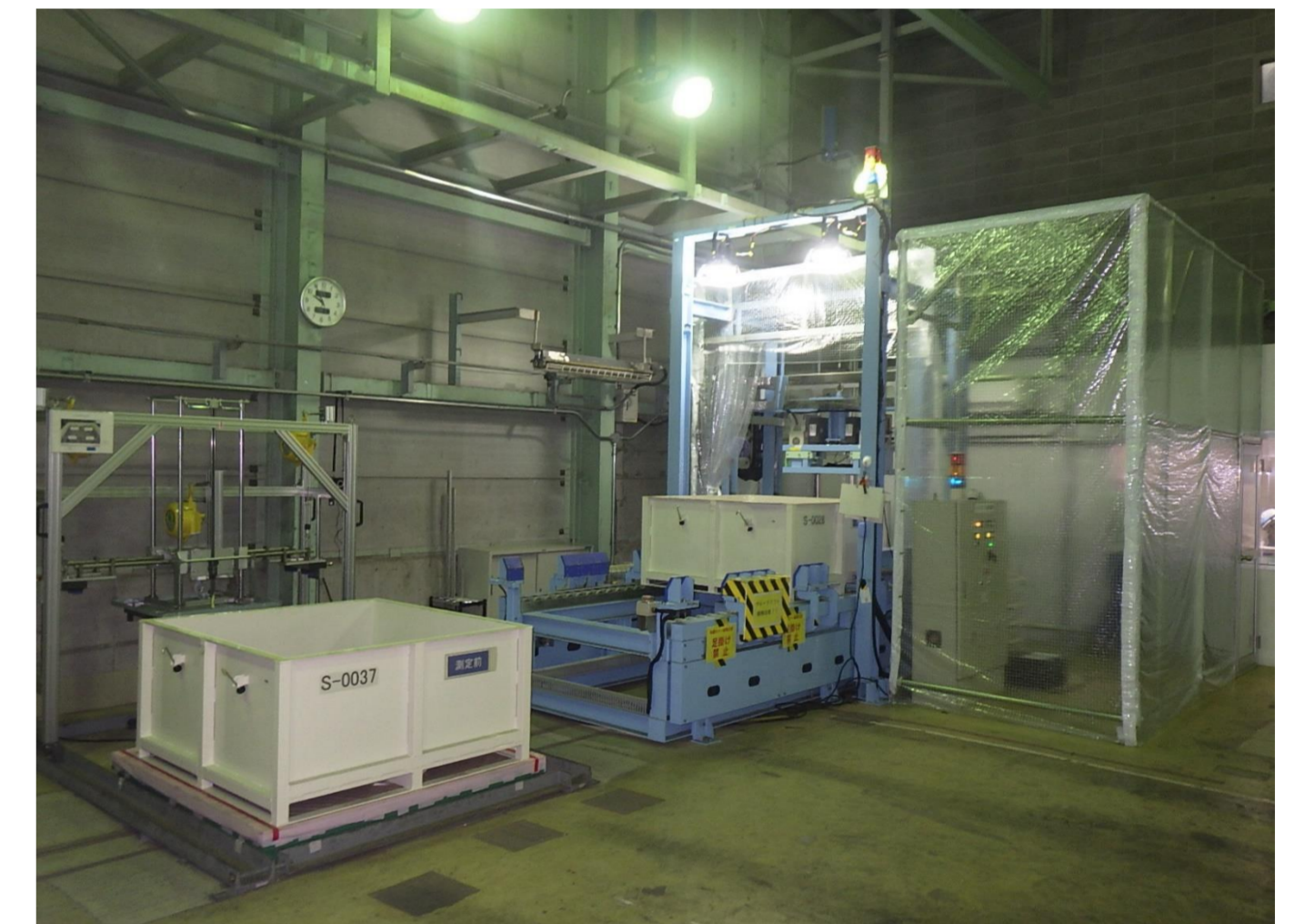
①解体撤去物を測定している様子
