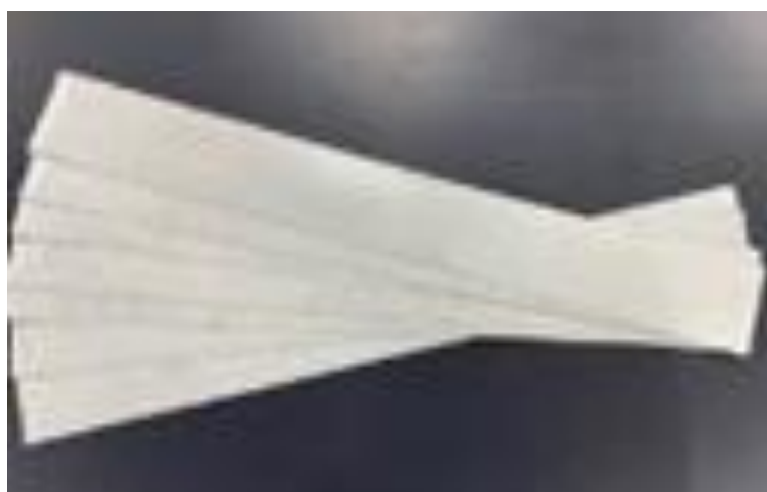
漏油検出シート
