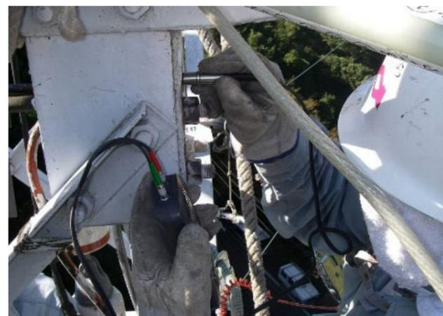
デプスゲージによる腐食による凹み量の測定
