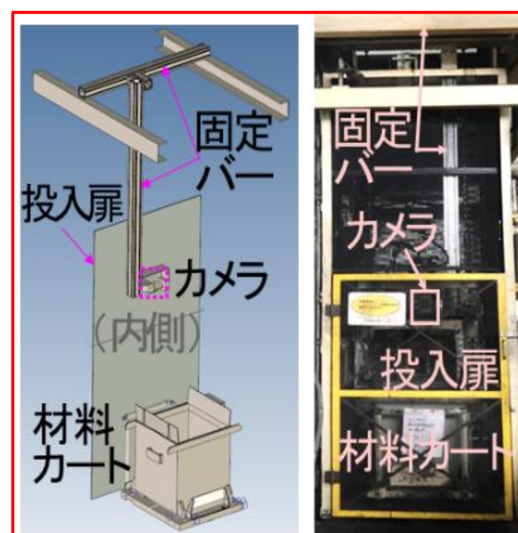
3Dカメラ設置状況
