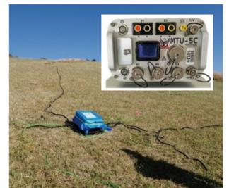
▲電磁探査装置 MTU-5C
