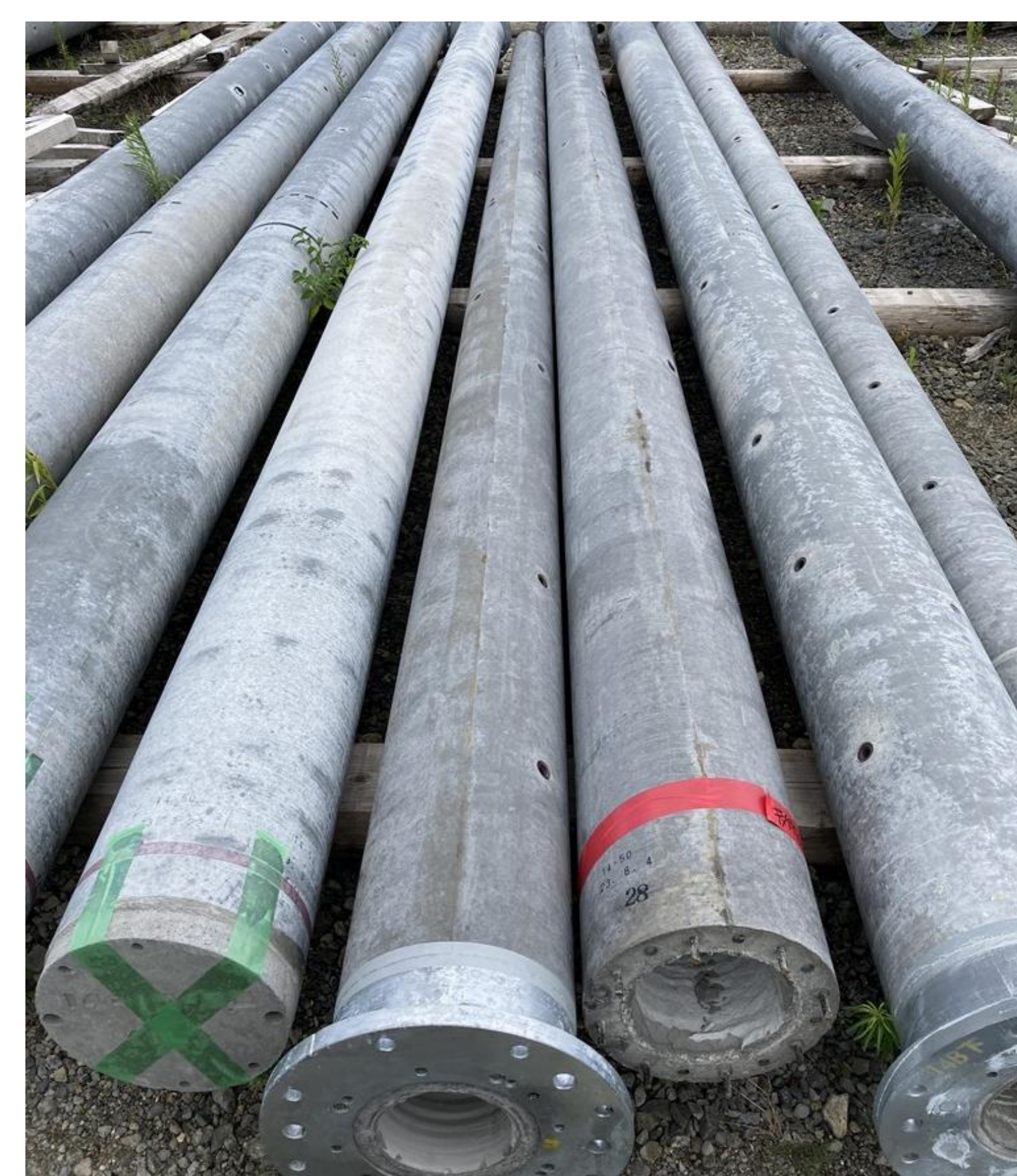
環境負荷低減型コンクリート柱の一例
