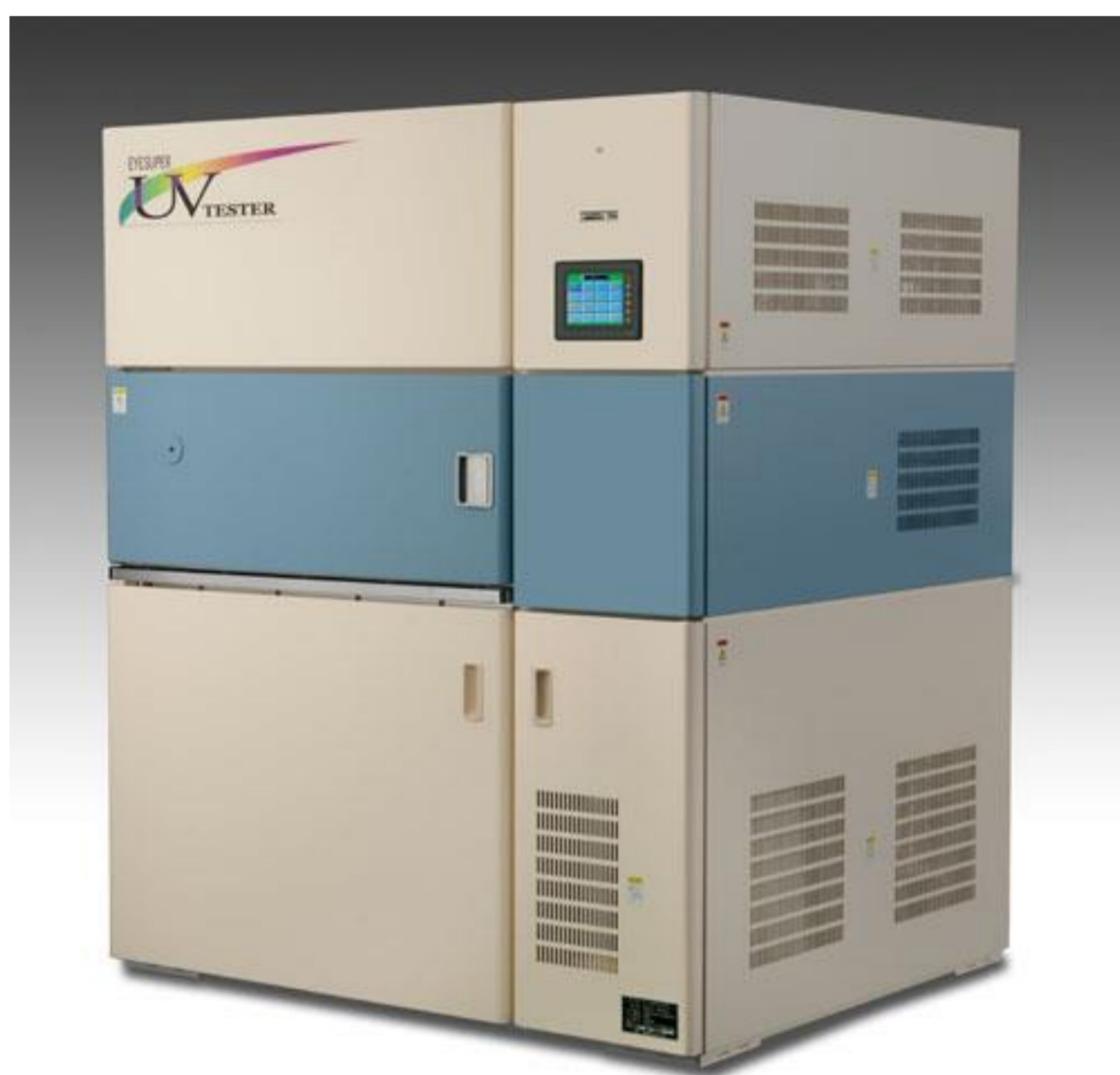
メタルハライドランプ式試験機 (左: 外観 右: 内部)
